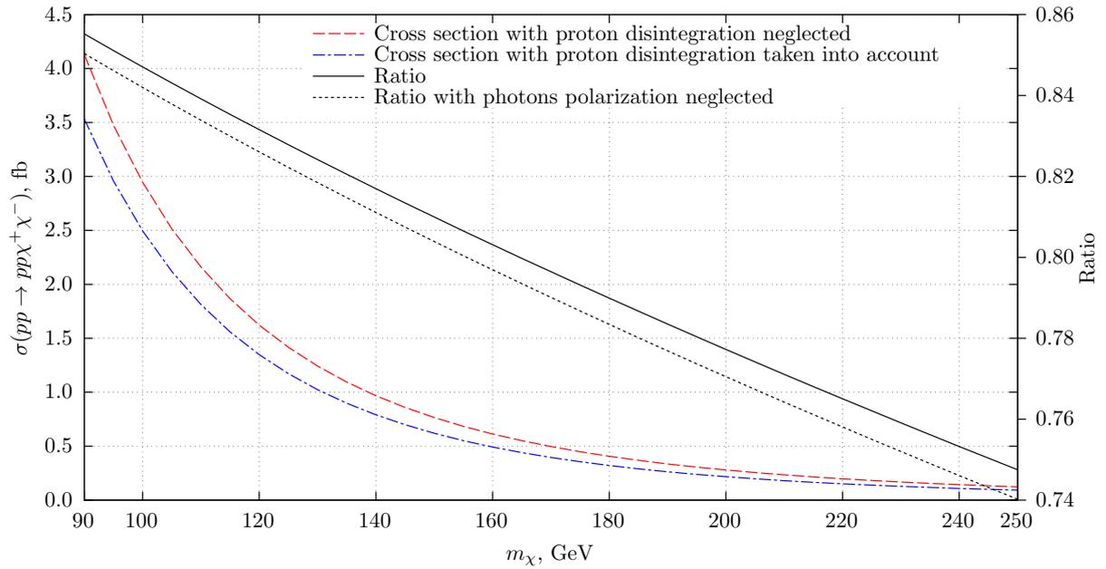
Рис. 4: Сечения (левая шкала) и их отношения (правая шкала) рождения пары заряженных фермионов  $\chi^+\chi^-$  в ультрапериферических столкновениях протонов с энергией 13 ТэВ в зависимости от массы частицы. Чёрная пунктирная линия (правая шкала) — это отношение сечений если пренебречь поляризацией фотонов в ультрапериферических столкновениях. Соответствующее сечение не показано, так как на этом рисунке его будет сложно отличить от синей штрих-пунктирной линии.
