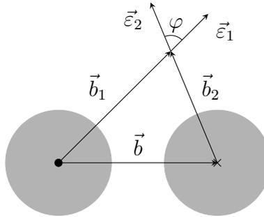
Рис. 1: Ультрапериферическое столкновение двух протонов, двигающихся перпендикулярно плоскости рисунка.  $\vec{b}_1$  и  $\vec{b}_2$  — радиус-векторы точки в плоскости столкновения относительно соответствующих протонов, в которой рассматривается столкновение фотонов.  $b = |\vec{b}_1 - \vec{b}_2|$  — прицельный параметр столкновения.  $\vec{\epsilon}_1$  и  $\vec{\epsilon}_2$  — вектора поляризации фотонов.
